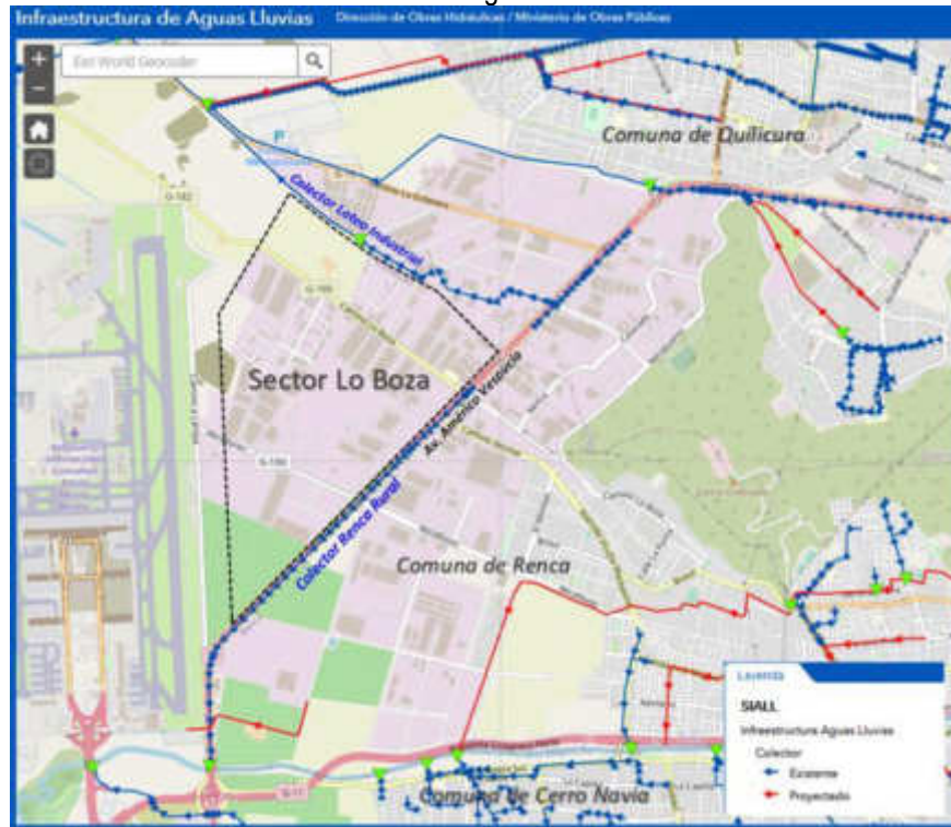
FIGURA °3 Infraestructura Aguas Lluvias. Sector Lo Boza
